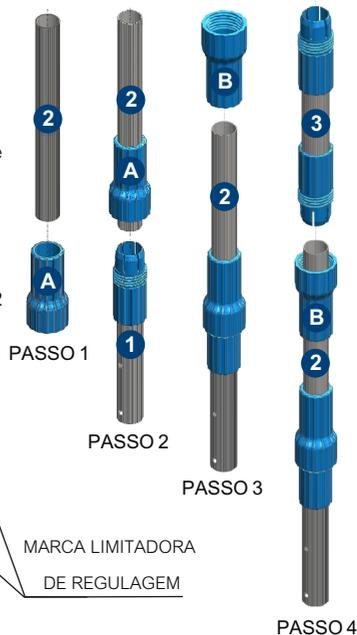
**⚠️ ATENÇÃO:** Durante a regulagem da altura do CABO DE ALUMÍNIO TELESCÓPICO, a fixação da TRAVA RÁPIDA (ITEM A, B e C) DEVE ser realizada dentro da MARCA LIMITADORA DE REGULAGEM e NUNCA deve ser ultrapassada, como mostra a figura ao lado:
