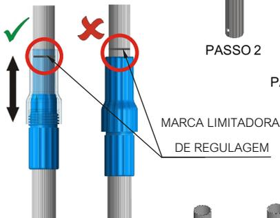
PASSO 5 - Encaixe a TRAVA RÁPIDA (ITEM C) no TUBO 4 (ITEM 4) no lado oposto do furo.
